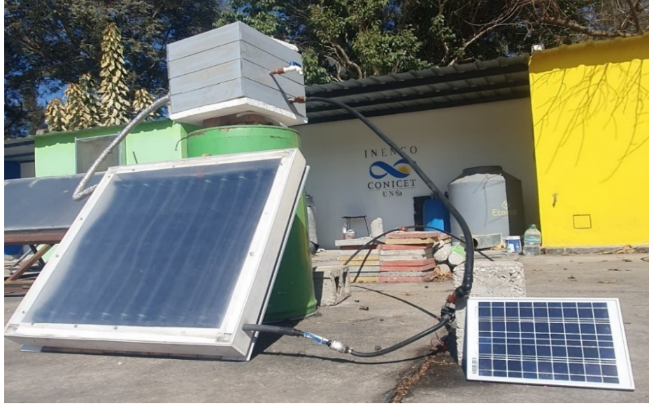
Figura 5: Sistema con recirculación forzada en funcionamiento (Bomba 12V CC y Panel fotovoltaico de 7 W).
