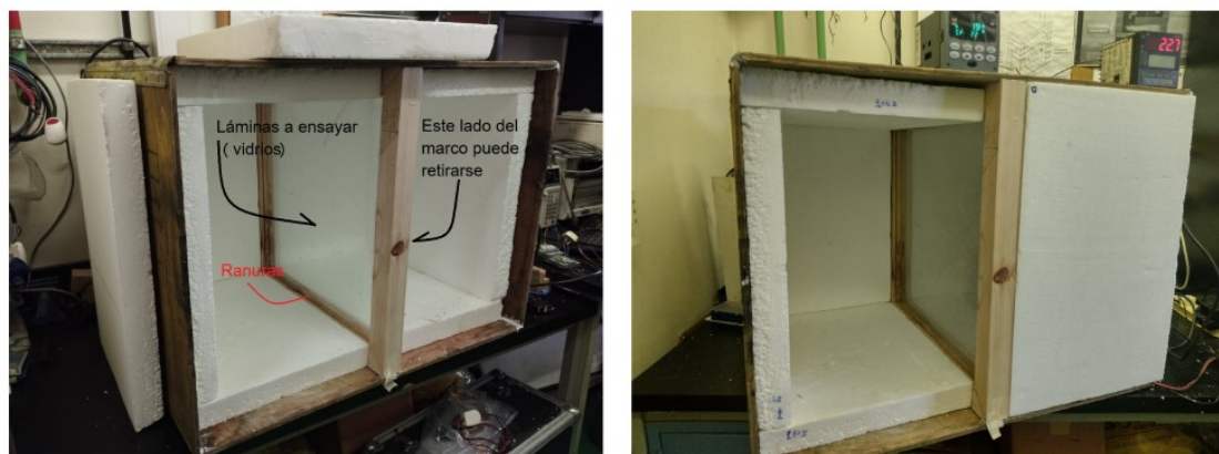
Figura 5: Izquierda: dispositivo abierto donde pueden observarse ambos recintos. Derecha: con el recinto derecho tapado y, sobre el techo, los controladores PID utilizados para controlar los dispositivos de calefacción y refrigeración de los recintos.
