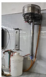
Figura 9: Destilador de laboratorio con sistema de alimentación continuo.
