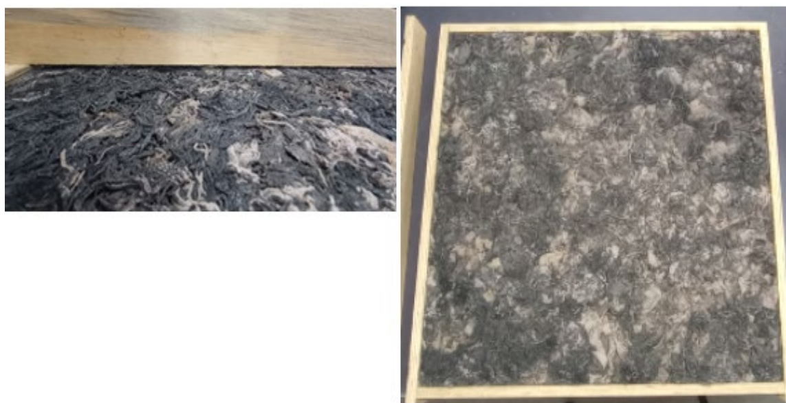
Figura 4: Placa recién desmoldada, detalle desnivel y enrasados con masilla y final con masilla de placas de roca yeso y masilla. Fuente: Autoría propia.
