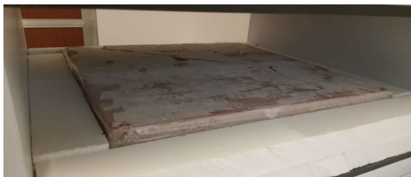
Figura 5: Placa Sistema LADRILLÓN en el equipo de medición en laboratorio A. Fuente: Autoría propia.
