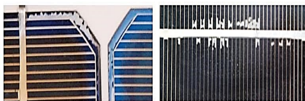
Figura 6: a) y b) Módulos con delaminación y pérdida de adherencia.
