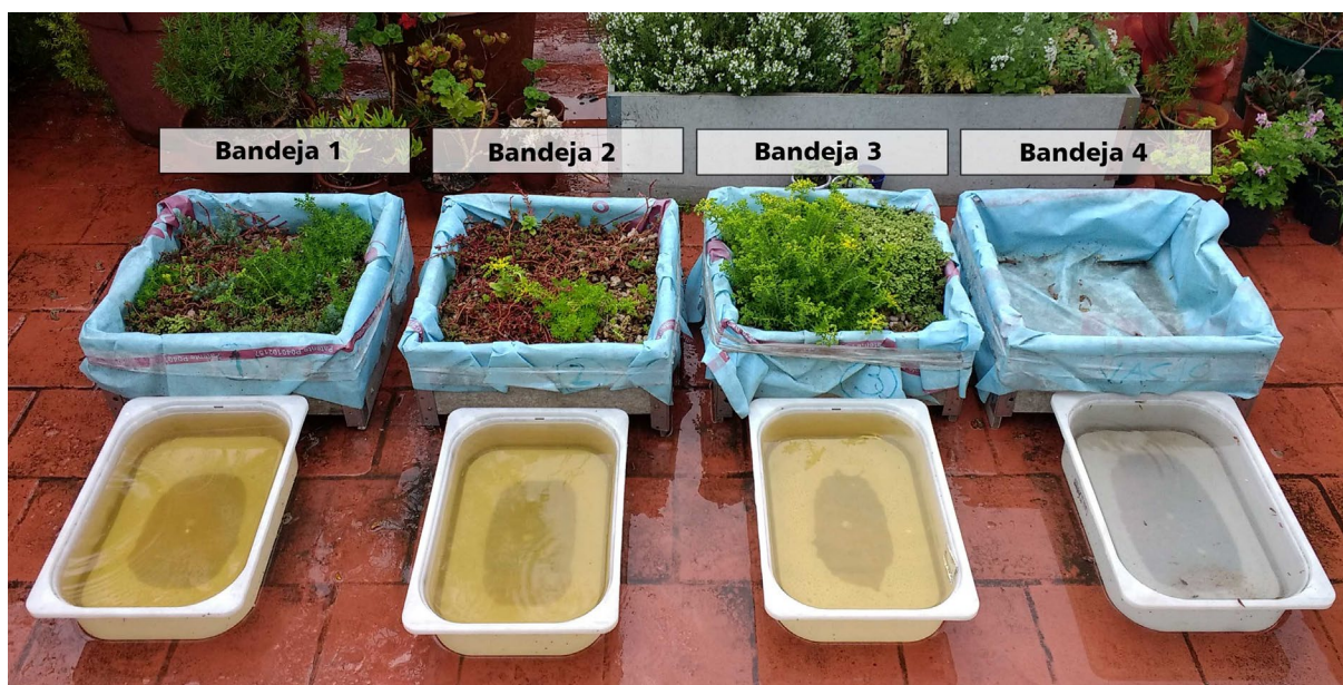
Figura 9: contenedores retirados luego de un evento de lluvias
