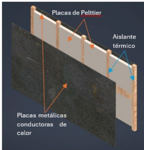
Figura 2: Diseño previo a la construcción del dispositivo realizado con el software de modelado 3D. Las medidas se encuentran dadas en milímetros.
