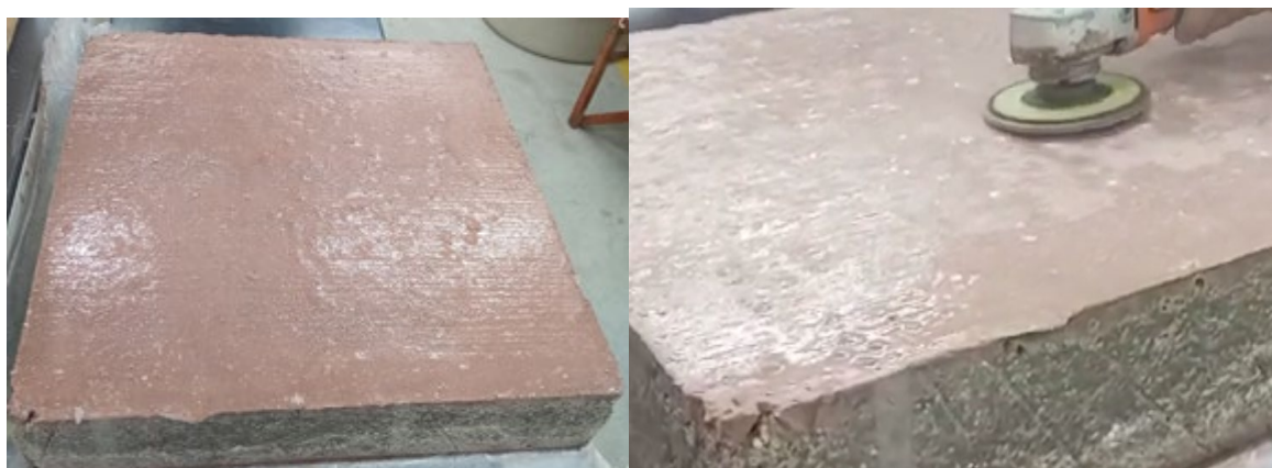
Figura 6: Placa recién desmoldada y detalle flapeo de grumos y enrasado final con masilla. Fuente: Autoría propia.
