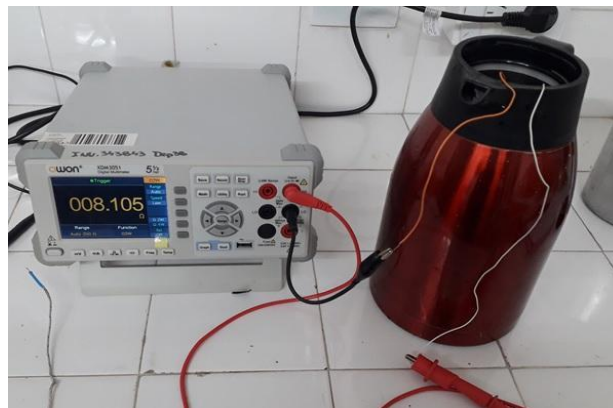
Figura 5: Configuración para la medición del coeficiente de resistividad térmica del platino.
