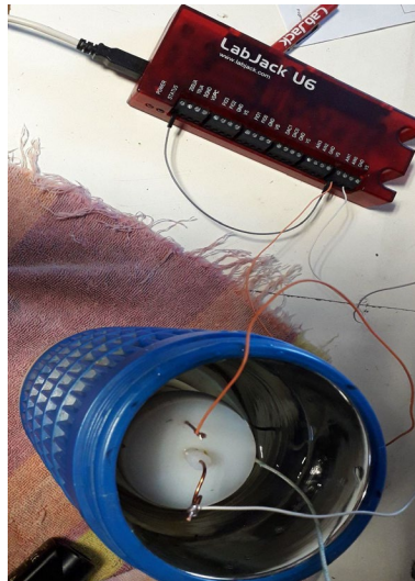
Figura 7: Fotografía de la celda de medición conectada al datalogger Lab Jack U6.
