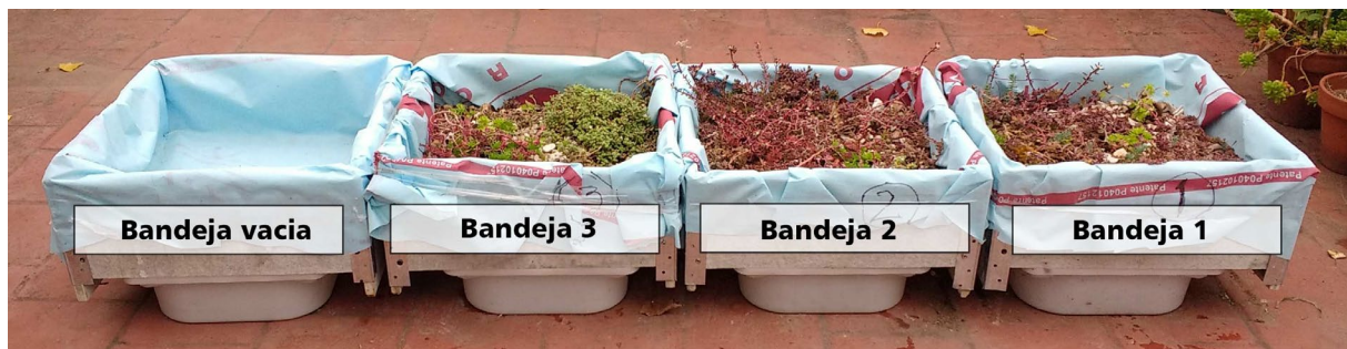
Figura 1: Bandejas con contenedor para retener agua durante cada evento de lluvias.
